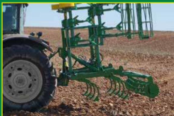
Plegado hidráulico con sistema de seguridad para el transporte.
