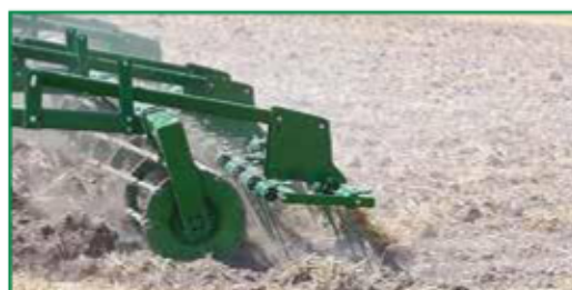
Cultichisel de elastómeros sin mantenimiento, fabricado en chasis de alto límite elástico y con brazos de 35x35 de gran despeje.
