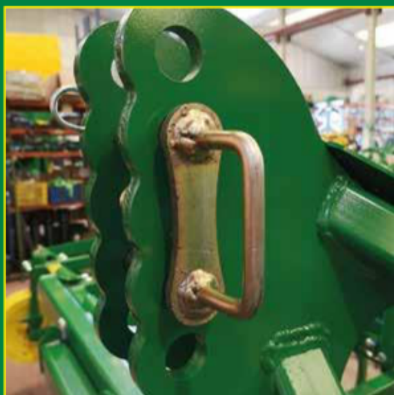
Enganche para distintos tractores y condiciones del terreno, con bulón antigiro.
